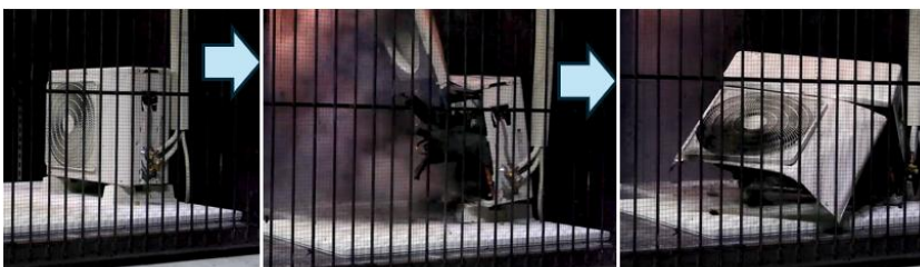
コンプレッサーに空気が混入して破裂した様子(再現実験)
